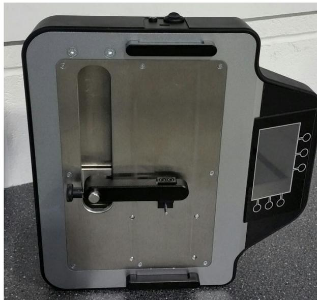
Notieren Sie den Wert, der bei der Kraftaufnehmer-Messung in Echtzeit angezeigt wird. Dies ist die Masse von Kraftaufnehmer und Schlittenkupplung.
