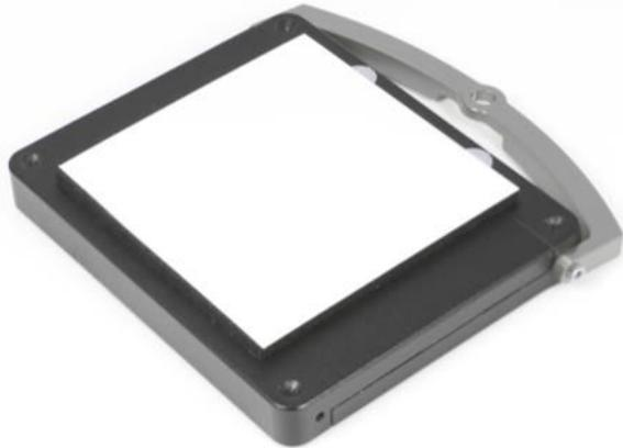
\* Der Schlitten wurde zusammen mit den Magnetstäben auf 200 g kalibriert. Falls die Magnetstäbe aus irgendeinem Grund nicht zur Sicherung der Probe verwendet werden können, befestigen Sie die Probe mit Klebeband und legen die Magnetstäbe oben auf den Schlitten.
