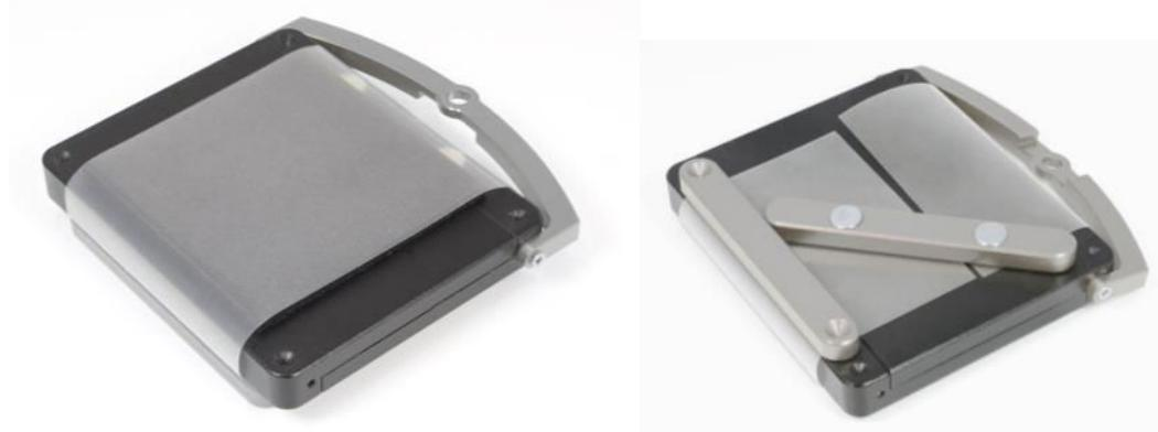
\* Der Schlitten wurde zusammen mit den Magnetstäben auf  $200 \text{ g}$  kalibriert. Falls die Magnetstäbe aus irgendeinem Grund nicht zur Sicherung der Probe verwendet werden können, befestigen Sie die Probe mit Klebeband und legen die Magnetstäbe oben auf den Schlitten.
