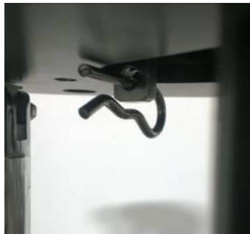
5. Legen Sie einen Reinigungsflicken über die obere Zylinderöffnung. Tippen Sie auf „Clean“ (Reinigen). Daraufhin drückt der Hebemechanismus den Reinigungsflicken mit dem Reinigungswerkzeug durch den Zylinder. Entfernen Sie den Flicken, wenn er unten aus dem Zylinder herauskommt. Wiederholen Sie diesen Vorgang dreimal mit einem neuen Flicken oder bis der Flicken sauber aus dem Zylinder herauskommt.
