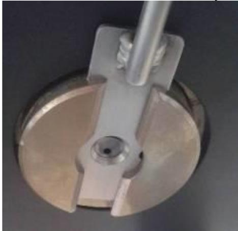
Düse und Gleitplatte zur Fixierung der Düse an korrekter Position – bereit für den Test.
