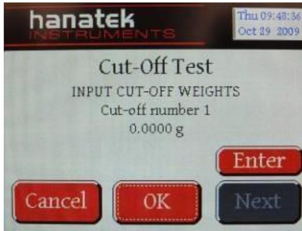
**Die Schmelzdichte (MD) wird für jeden Abschnitt berechnet, indem die Strecke, die für diesen Abschnitt zurückgelegt wurde, gemessen wird. Aus diesem Grund ist es wichtig, jeden Abschnitt in der richtigen Reihenfolge einzugeben.**
