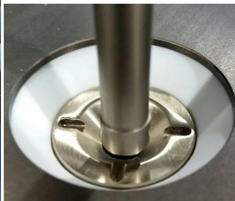
6. Wenn eine Anpassung der Ausrichtung erforderlich ist, können die mit einem Gewinde versehenen Positionierungsstäbe, die sich an der Gewichtsplattform befinden, nach oben oder unten reguliert werden. Auf diese Weise wird der Kolben präzise an die Ausrichtung des Zylinders angepasst. Verwenden Sie einen Innensechskantschlüssel, um die Stützstäbe nach oben bzw. unten zu bewegen.
