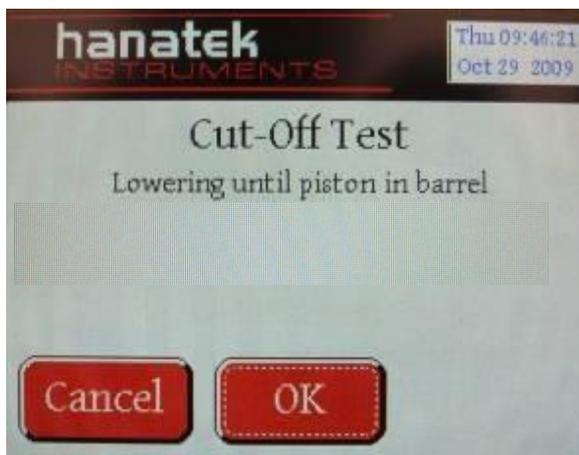
7. Die Gewichtplattform wird bis zum Boden abgesenkt, sodass durch das Testgewicht jeglicher Polymerüberschuss während der Konditionierzeit durch den Zylinder gedrückt wird. Sobald der Kolben den Testbereich erreicht, fährt der Gewicht-Hebemechanismus wieder hoch und hält den Kolben für den Rest der voreingestellten Konditionierzeit am Beginn des Testbereichs.
