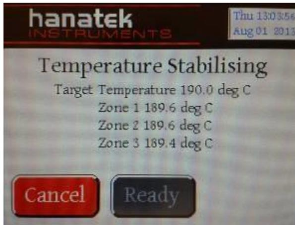
Sobald die ausgewählte Testtemperatur erreicht ist, wechselt das Gerät automatisch zum Bildschirm für die ISO-Temperaturprüfung. Es vergleicht die internen Sensoren mit den Sensoren im Fühler.
