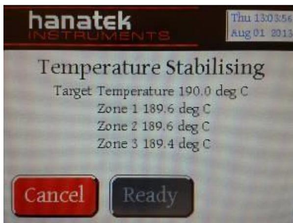
4. Der Gerätezylinder wird auf die voreingestellte Temperatur aufgeheizt. Der Benutzer kann erst dann mit der nächsten Testphase fortfahren, wenn die korrekte Temperatur erreicht ist. Wenn die Testtemperatur erreicht ist, wird die Schaltfläche „Ready“ (Bereit) verfügbar. Durch Auswahl der Schaltfläche „Ready“ (Bereit) wird der Kolben aus dem Zylinder hochgefahren.
