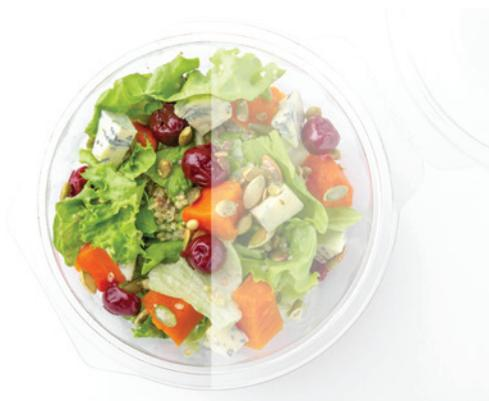
*Damit das Produkt klar und scharf zu sehen ist, sollte die Folie in dem Betrachtungsabstand, der durch die Verpackung vorgegeben ist, einen minimalen Haze aufweisen. In diesem Beispiel ist gut zu erkennen, dass der Verpackungsinhalt auf der linken Seite ohne Folie sehr klar zu sehen ist, während er auf der rechten Seite unter der Folie trüb erscheint, was auf Haze hinweist.*
