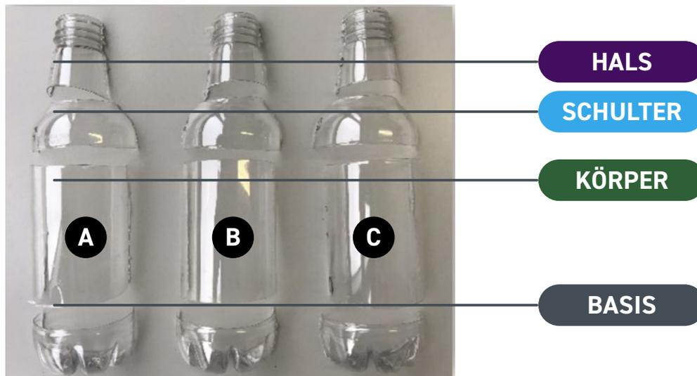
**SCHRITT 1:** Es wurden Proben von drei verschiedenen PET-Flaschen getestet, die vom Kunden bereitgestellt wurden. Optisch wurden alle Flaschen als „wasserweiß“ mit niedrigem Haze eingestuft. Jede Flasche (A, B und C) wurde für die Messung mit dem Rhopoint ID-L in 4 Teile zerschnitten, die folgendermaßen gekennzeichnet wurden: Hals | Schulter | Körper | Basis.
