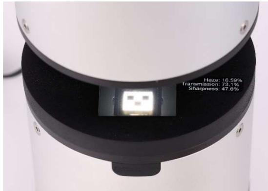
Der Standard wird mit Magneten fixiert. Stellen Sie sicher, dass die Rückseite des Standards an den Kanten des Gerätegehäuses ausgerichtet ist.
