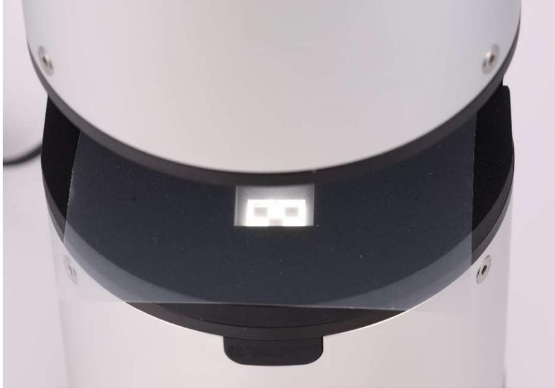
Für viele Anwendungen wird bei der Messung standardmäßig das ASTM Haze-Distanzstück verwendet.
