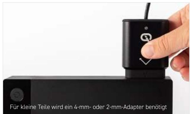
Für kleine Teile wird ein 4-mm- oder 2-mm-Adapter benötigt
