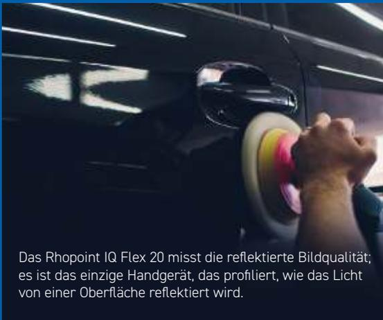
Das Rhopoint IQ Flex 20 misst die reflektierte Bildqualität; es ist das einzige Handgerät, das profiliert, wie das Licht von einer Oberfläche reflektiert wird.
