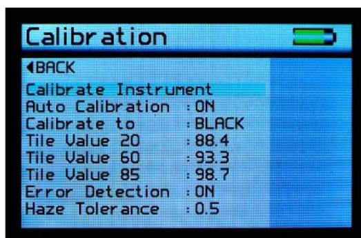
構成設定画面は装置の校正をユーザーの好みに設定することが出来る画面です。セットアップ画面はユーザーの好みで装置をカスタマイズするために使います。上下ボタンでオプションを選択し、エンターボタンで決定します。選択可能な設定は下記のものがあります。
