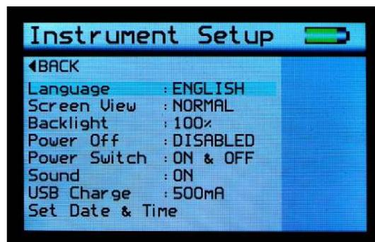
装置設定画面では装置の基本的な操作環境をユーザーの好みに設定することができます。上下ボタンでそのオプションに移動し、エンターボタンで決定します。
