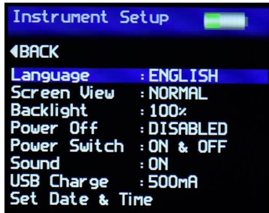
Im Geräteeinstellung-Bildschirm können die grundlegenden Betriebseinstellungen des Geräts an die Anforderungen des Benutzers angepasst werden. Navigieren Sie mit den Auf-/Ab-Tasten durch die Optionen, und drücken Sie die Eingabetaste, um die gewünschte Option auszuwählen.
