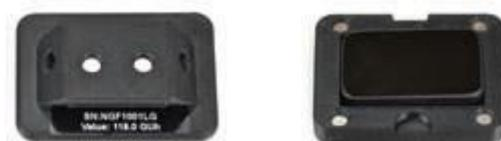
14. Im Falle von Verunreinigungen reinigen Sie die Kalibrierplatte mit dem im Lieferumfang enthaltenen fusselfreien Reinigungstuch. Verwenden Sie keine Lösungsmittel oder Reinigungsflüssigkeiten.
