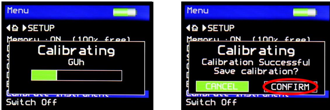
11. Eine spezielle Funktion des Novo-Gloss Flex 60 überprüft, ob die korrekte Kalibrierplatte für den Kalibrierbereich ausgewählt wurde oder ob sich Verunreinigungen auf der Kalibrierplatte befinden. Bei einem Fehler wird die folgende Meldung angezeigt:
