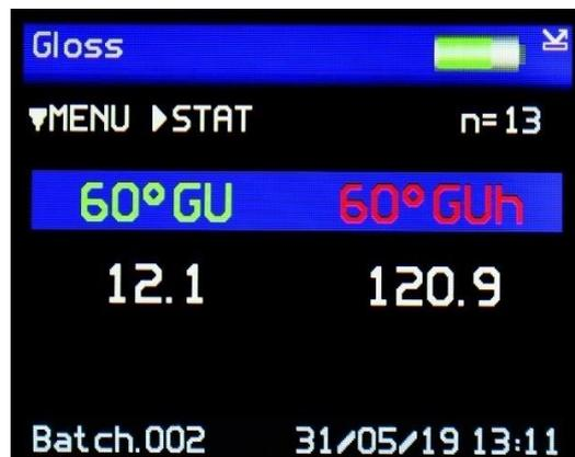
Drücken Sie die Rechts-Taste, um zum Statistikbildschirm der aktuellen Charge zu wechseln. In diesem Bildschirm können Messungen durchgeführt werden – die Statistik wird aktualisiert.
