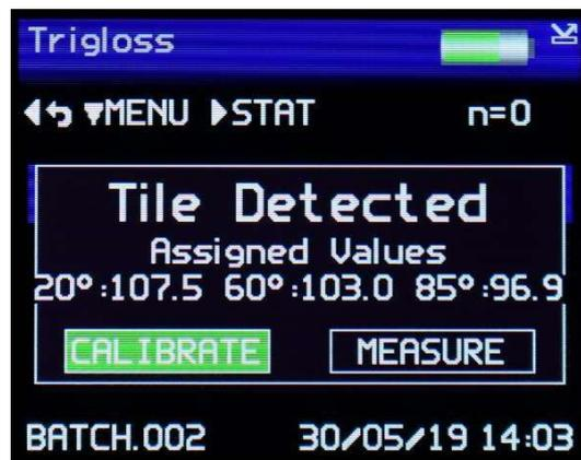
Zwei Optionen stehen zur Verfügung: Sie können entweder das Gerät auf der Kalibrierplatte kalibrieren (CALIBRATE), bevor Sie eine Messung vornehmen, oder Sie messen (MEASURE), ohne zu kalibrieren. Die gewünschte Option kann über die Links-/Rechts-Tasten (3) und die Eingabetaste (4) auf dem Tastenfeld ausgewählt werden.
