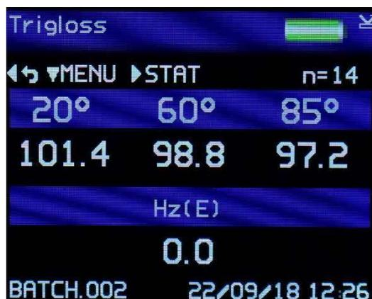
Bei Auswahl von ASTM E430 wird „(E)“ neben dem Hz-Parameter angezeigt. Bei Auswahl von ASTM D4039 wird „(D)“ neben dem Hz-Parameter angezeigt.
