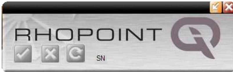
5. Die Schaltflächen sind abgeblendet, während Data Widget nach eingeschalteten IQ-Geräten sucht, die mit dem PC gekoppelt wurden.
