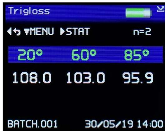
Drücken Sie die Rechts-Taste im Startbildschirm, um den Glanz-Statistikbildschirm der aktuellen Charge für alle drei Winkel anzuzeigen. In diesem Bildschirm können Messungen durchgeführt werden – die Statistik wird aktualisiert.
