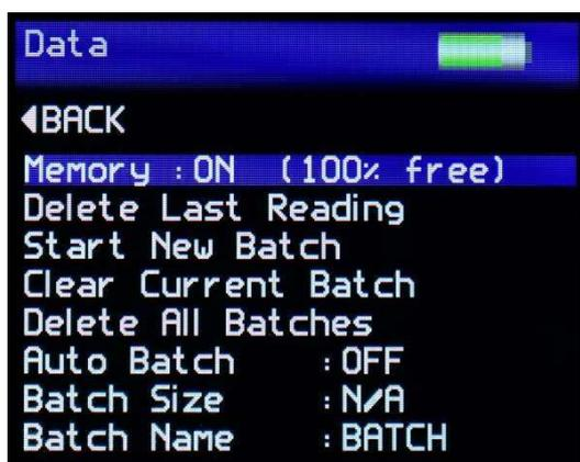
Der Daten- und Chargen-Bildschirm ähnelt in seiner Funktionalität dem Menübildschirm, ermöglicht jedoch auch die Auswahl und Einstellung der automatischen Chargengröße (Auto Batch).
