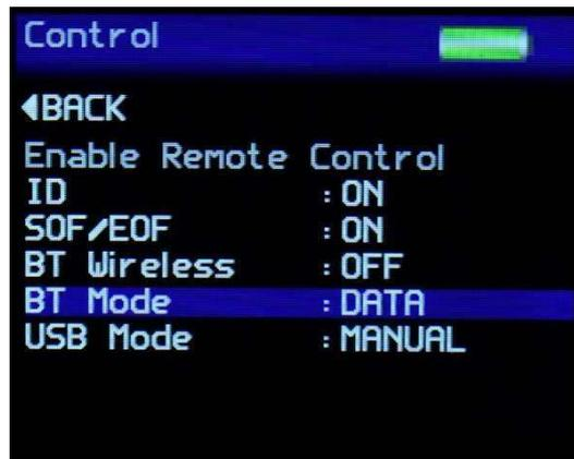
Im Kontrollbildschirm können die Bluetooth-Parameter des Geräts an die Anforderungen des Benutzers angepasst werden. Navigieren Sie mit den Auf-/Ab-Tasten durch die Optionen und drücken Sie die Eingabetaste, um die gewünschte Option auszuwählen.
