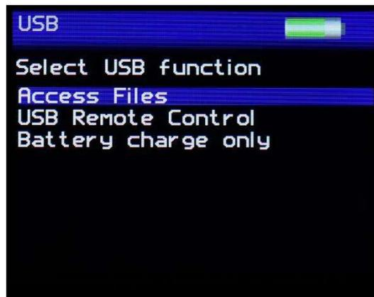
Auf Dateien zugreifen (Access Files) – Ermöglicht den Zugriff auf Mess- und Konfigurationsdateien auf dem Gerät. Das Gerät wird als USB-Laufwerk mit dem Namen NG-METER angezeigt. Bei Auswahl dieser Funktion wird auf dem Gerätedisplay ein USB-Speicherstick wie unten dargestellt angezeigt:
