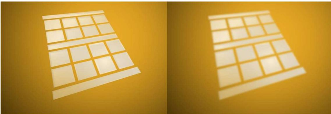
Wird die Reflexion einer hellen Lichtquelle auf einer Oberfläche mit stark ausgeprägtem Haze betrachtet, liegen „Glanzschleier“ über dem Bild und es ist von einem hellen Lichthof umgeben.
