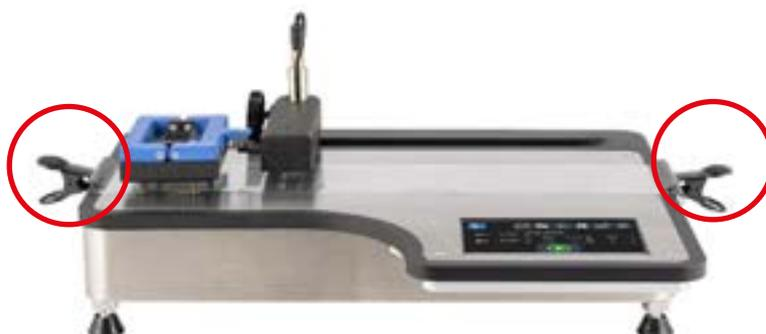
Die Probengröße für den Schlitten sollte 63,5 mm im Quadrat betragen. Bei der Messung flexibler Proben kann die Größe 63,5 x 148 mm betragen und um den Schlitten gewickelt werden. Die Schaumstoffunterlage an der Unterseite gewährleistet eine Kontaktfläche von 63,5 mm im Quadrat.
