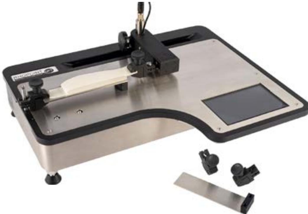
Für den 180°-Schälversuch sollte der UFT wie in der obigen Abbildung gezeigt konfiguriert werden.
