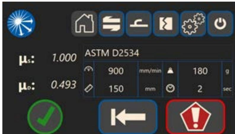
Wenn der Test erfolgreich abgeschlossen ist, wird der folgende Bildschirm angezeigt und die statischen und dynamischen COF werden auf der linken Seite des Bildschirms angezeigt.
