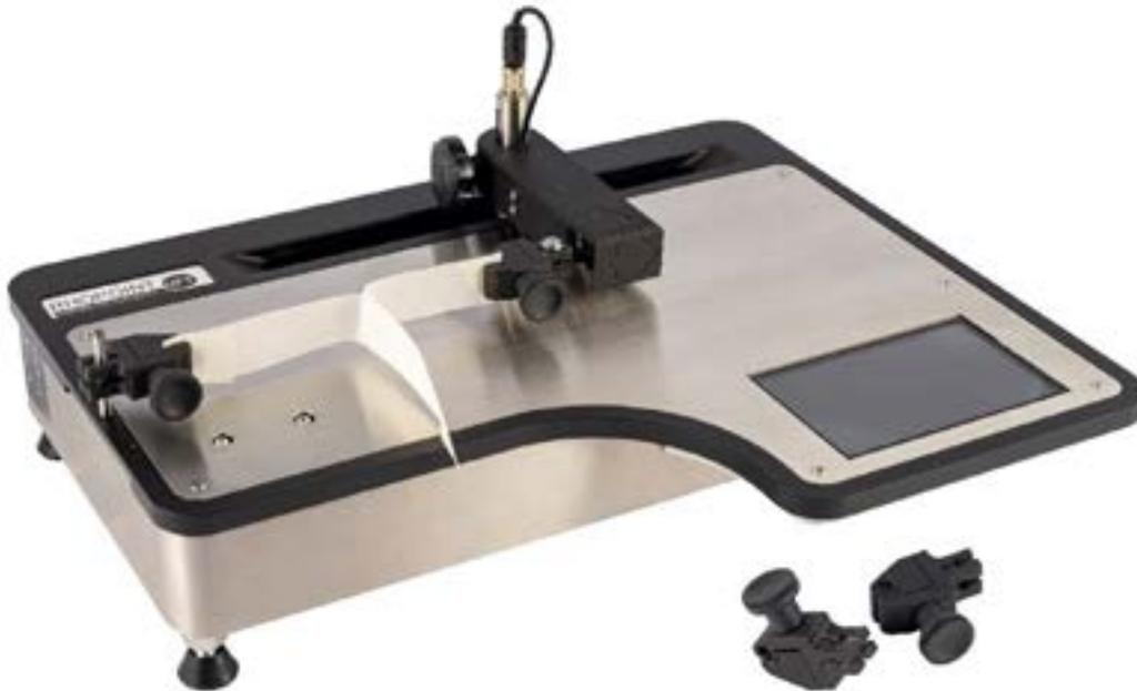
Für die Siegelnahtprüfung sollte der UFT wie in der obigen Abbildung gezeigt konfiguriert werden.
