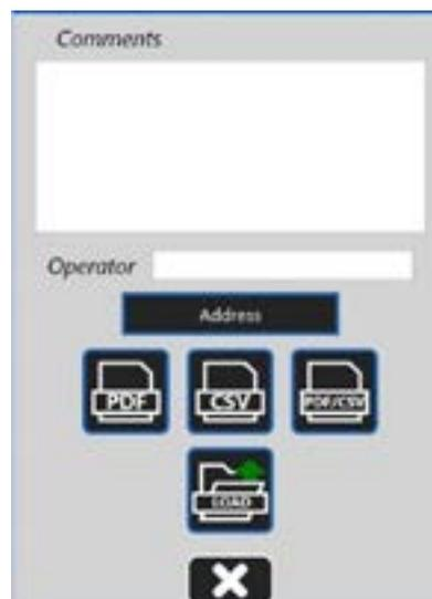
In diesem Fenster können die Ergebnisse in verschiedenen Formaten ausgegeben werden. Der Hauptkommentarbereich ermöglicht es dem Benutzer, Details über die Probe einzugeben.
