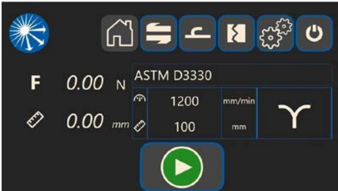
Drücken Sie die Taste
